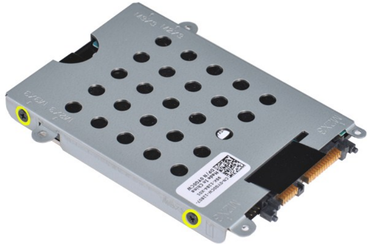
6. הרם את מסגרת הכונן הקשיח והוצא אותה מהכונן הקשיח.
