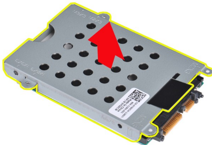
6. הרם את מסגרת הכונן הקשיח והוצא אותה מהכונן הקשיח.
