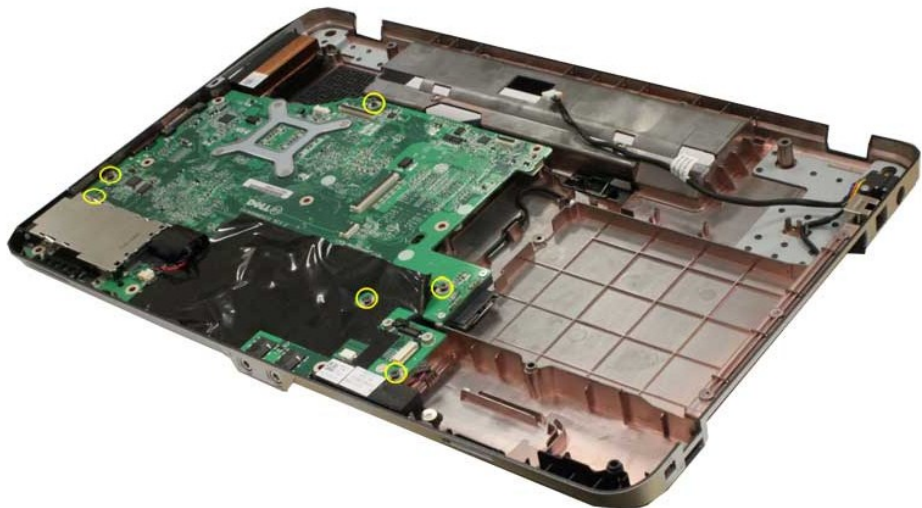
19. הרם את לוח המערכת והרחק אותו ממארז המחשב.
