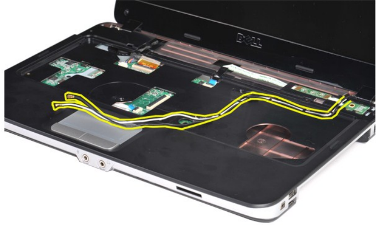
12. טובב את תפס הכבלים של הופך התצוגה כדי לנתק את הכבל של הופך התצוגה.
